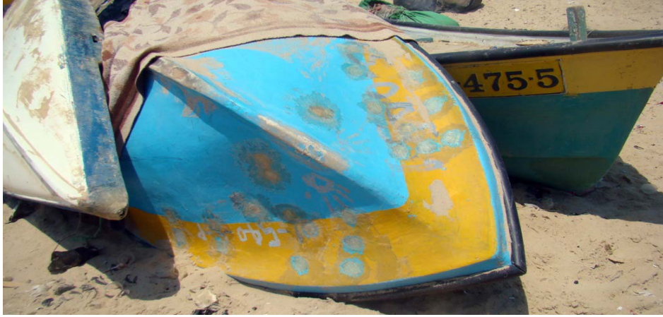
صورة رقم (1): آثار ثقب أحدثتها أعبرة نارية على قارب صيد تمت تغطيته بمادة الفيبر غلاس
